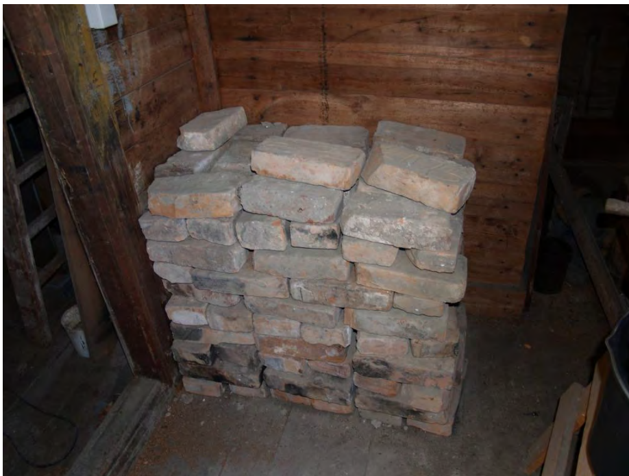
2015-04-16: Alla tegelstenar har samma format: 300x150x65 mm.
