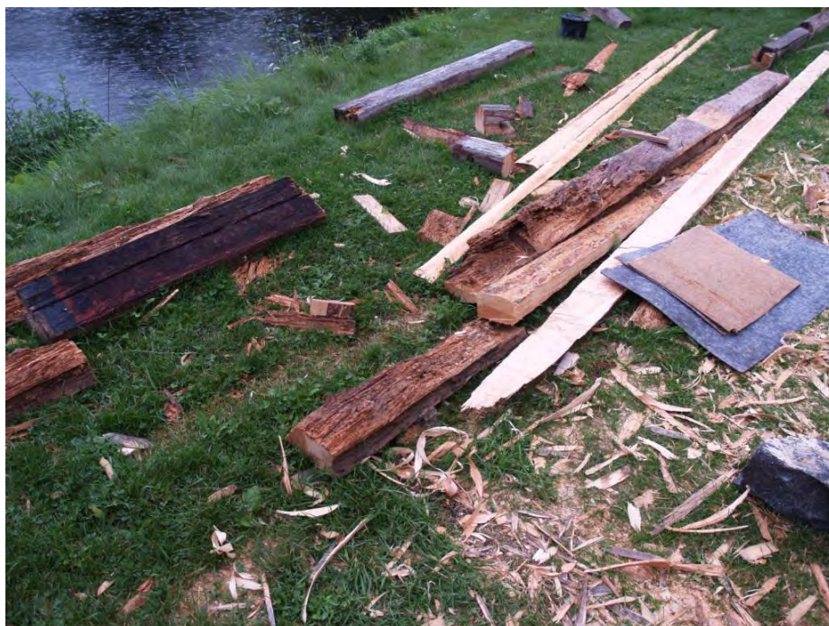
2015-09-02: Ytan var fin, men inuti var stockarna förstörda av röta.
