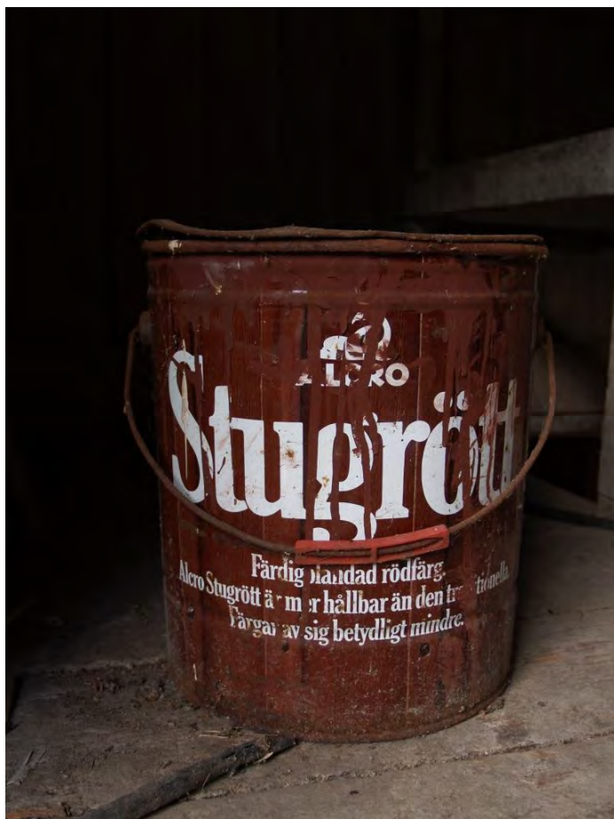
2015-08-12: Troligen målades kvarnen senast med Alcro's stugrött. Polyvinylacetat-emulsion har blandats med slamfärgen och det är därför den flagar annorlunda än äkta slamfärg.
