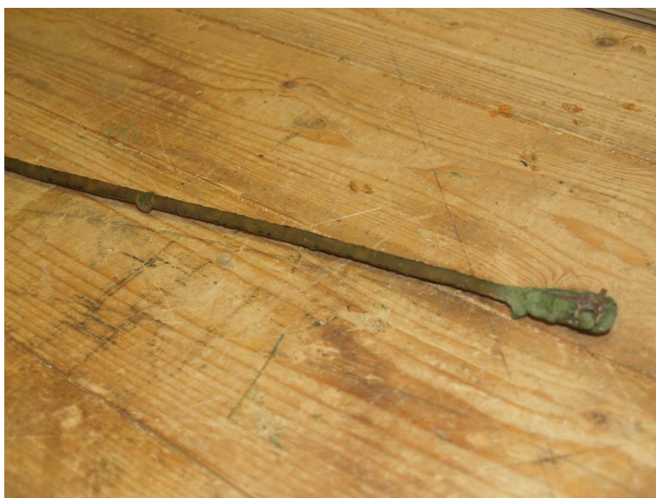
2019-04-24: Stormjärnen var spikade med trådspik, vilket visade att renoveringar hade genomförts.
